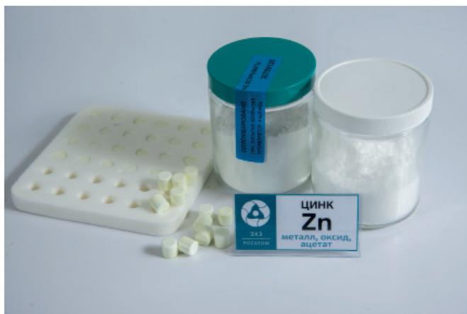
Добавление цинка в форме оксида (таблетки) или ацетата (порошок) снижает образование кобальта-60. Однако если вводится природный цинк, то под облучением потоком нейтронов изотопы цинк-64 преобразуются в радиоактивные изотопы цинк-65, которые также увеличивают мощность дозы облучения.
